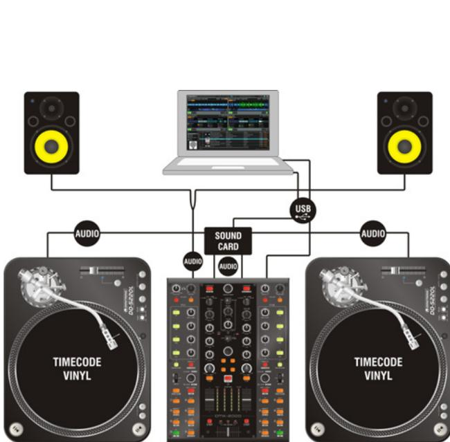
Typisches DVS-Setup unter Traktor und Serato
