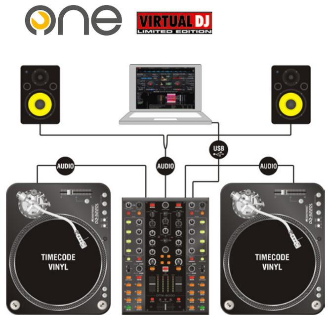
Typisches DVS-Setup unter Virtual DJ
